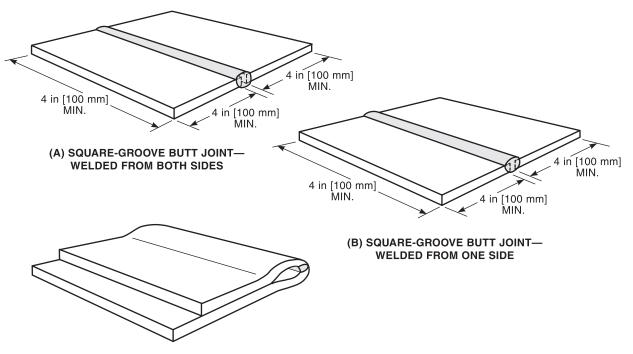
(C) WELDED JOINT AFTER COMPLETION OF BENDING
